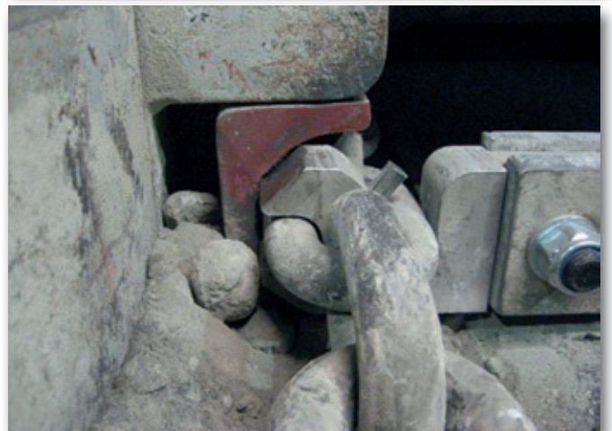
Fijaciones de los arrastradores con ajuste por empuje universales, dan a los operadores la posibilidad de reutilizar los arrastradores existentes montando tramos de cadena más largos.
