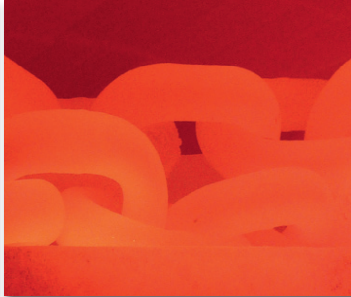
Tratamiento térmico de cadenas eslabonadas
